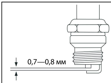
Зазор между электродами должен составлять 0,7-0,8 мм.
